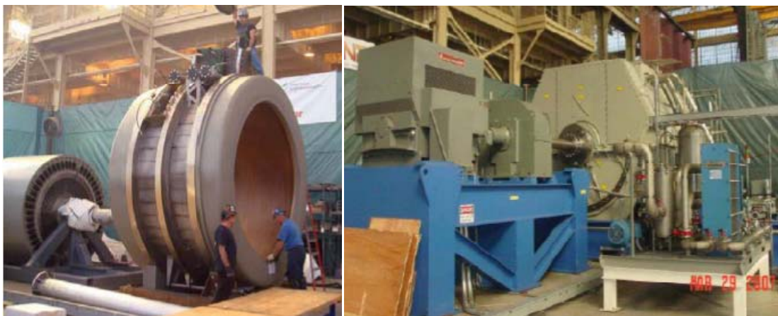
Figure II.1: Moteur SHTC (36.5 MW), produit par AMS pour la propulsion de navires.
