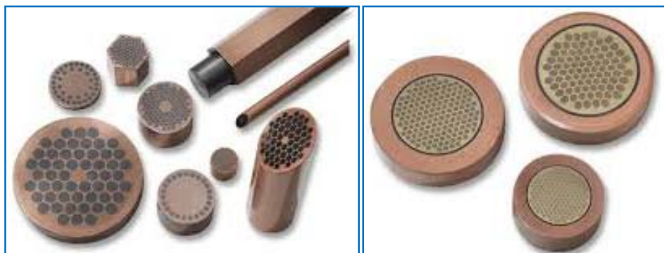
Figure I.14: Formes des deux matériaux SBTC : Nb 3 Sn à droite et NbTi à gauche.
