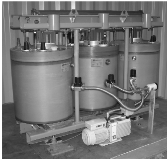
Figure I.27 : Transformateur SHTC développé par une équipe « New-Zeland /australien » montrée lors de l'assemblage (1MVA, 11/0.4 KV)
