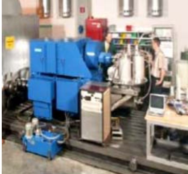
Figure II.2: Banc d'essais d'une génératrice SHTC (4 MVA) produit par Siemens [Nic07].
