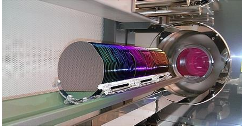
Figure II.13 : Entrée de lots dans un tube de type TEMPRESS
