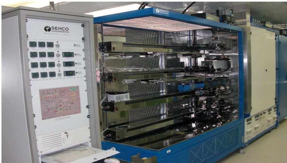
Figure II.2 : Four PECVD de diffusion et Dépôt de couche de nitrure (Semco)
