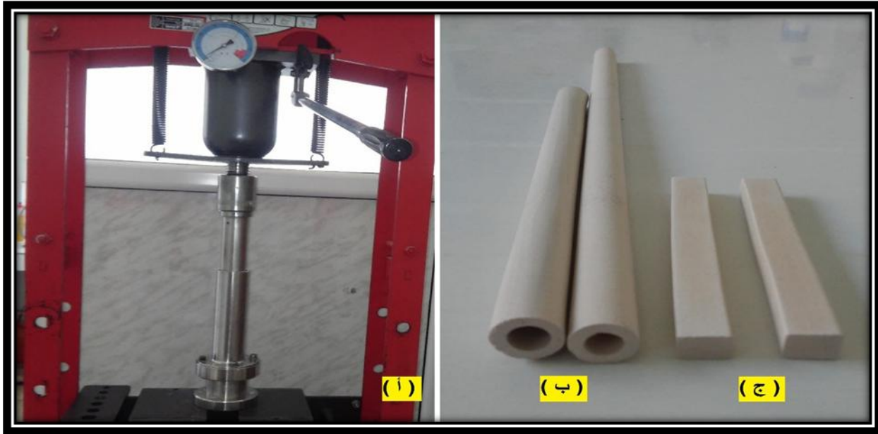
الشكل III-3 أ - آلة الاستخراج ، ب - مساند أنبوبية ، ج - مساند مستطيلة الشكل.
