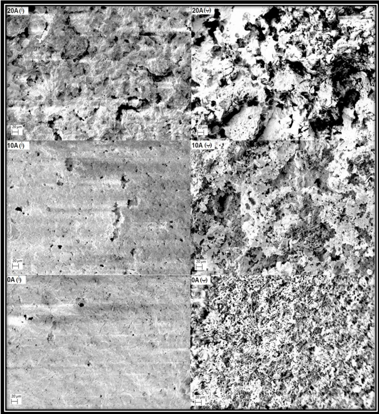
الشكل 18-IV البنية المجهرية لعينات الدياتوميت + نسب مختلفة من الألومينا المضافة
