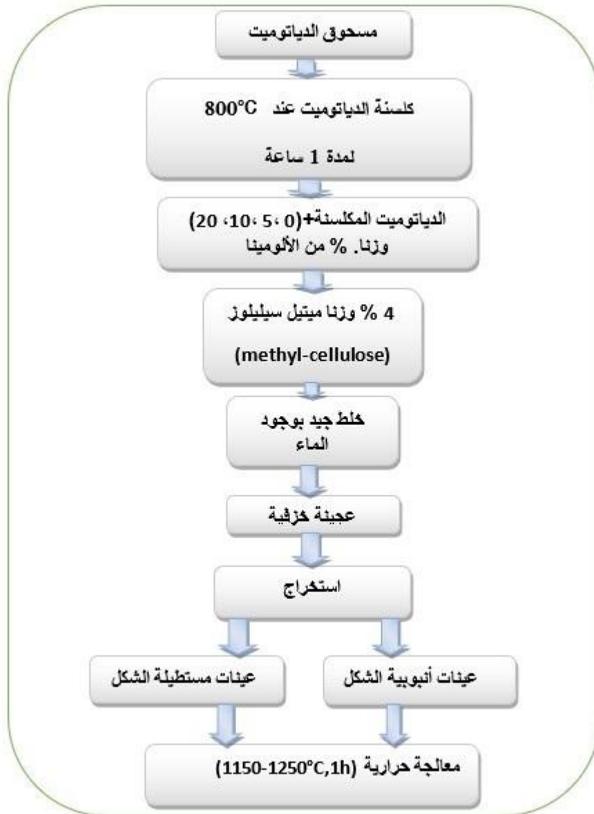
الشكل III -5 مخطط يوضح المراحل المتبعة في عملية تحضير المساند.
