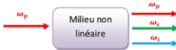
Figure 1.5. Principe de la génération paramétrique optique
