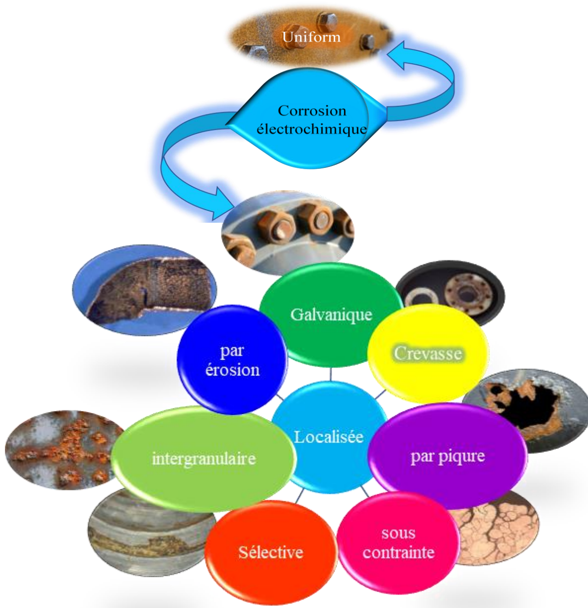
Figure I.5 : Les principaux types de dommages dus à la corrosion.
