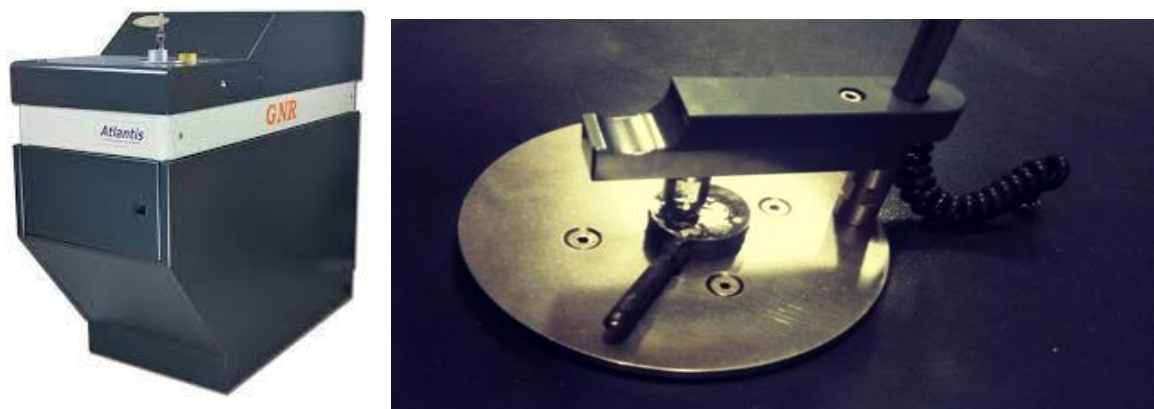
Figure II.2. a) Spectromètre d'émission optique, b) placement d'échantillon dans le spectromètre.
