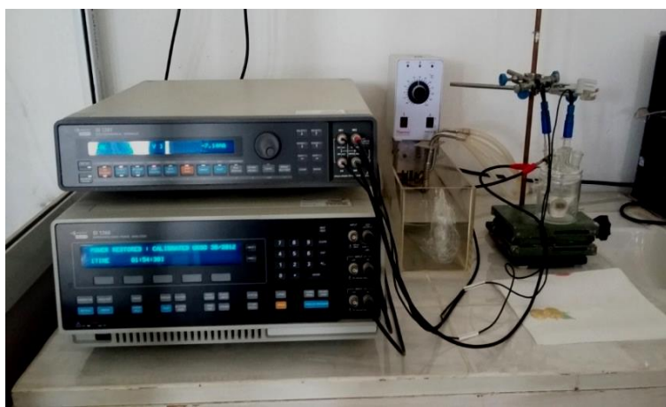
Figure II.6 : Dispositif expérimentale et cellule électrochimique de mesure avec un montage à trois électrodes.
