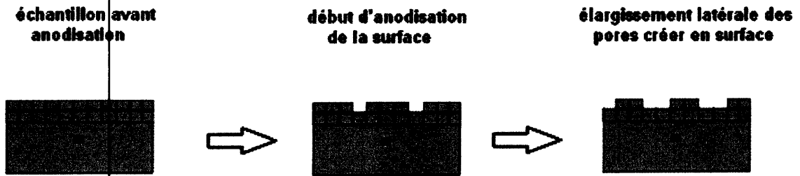
Figure 13. Représentation schématique de l'évolution de la morphologie des échantillons en fonction de la durée d'anodisation.
