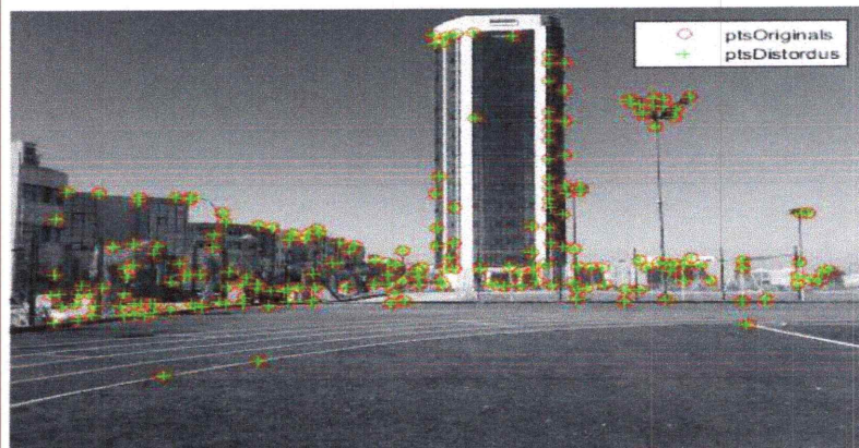
Figure IV.12: Les plus importants coins qui correspondent des deux images originale et compressée.
