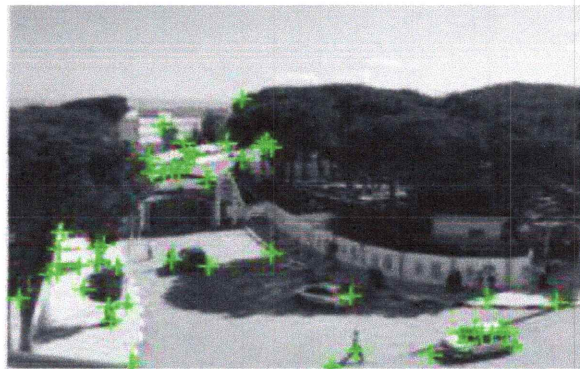
Figure III.2 : Détection de points d'intérêt par la méthode de Harris.
