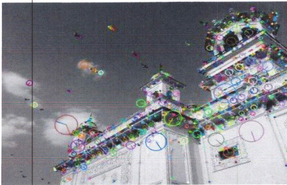
Figure III.4 : Exemple de points d'intérêt détectés par SIFT.
