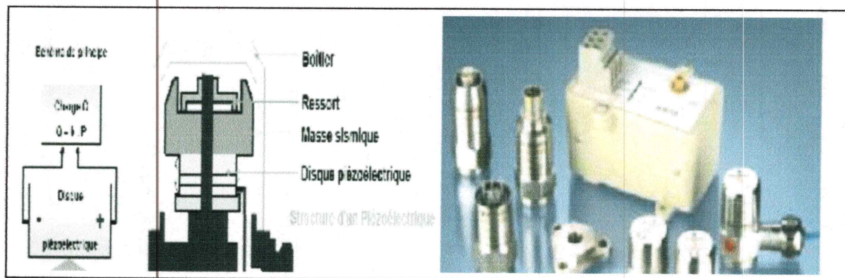
Fig.I.12 : Capteur d'accélération (accéléromètre). [1]
