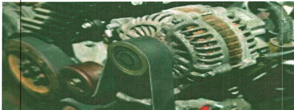
**Figure I.9 :** Exemple d'une transmission par courroies.
