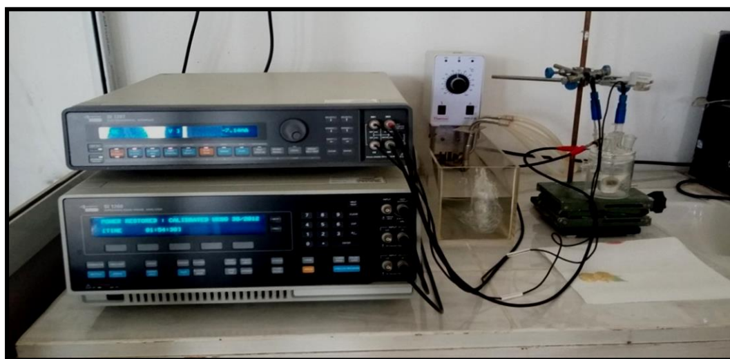
Figure II.2 : Dispositif de mesure électrochimique.
