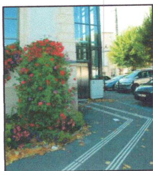
Figure-I-34 : Cheminement tactile guidant vers l'ascenseur
