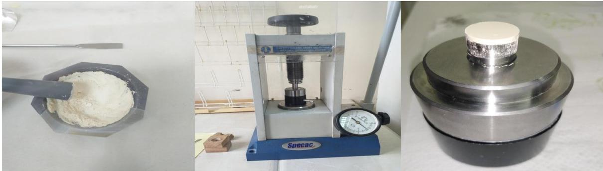
**Figure II. 3** : (a) - mortier en agate, (b) - Presse hydrostatique et moule en acier inoxydable.
