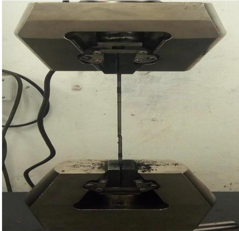
**Figure III-16:** La machine de traction pour le fil à machine
