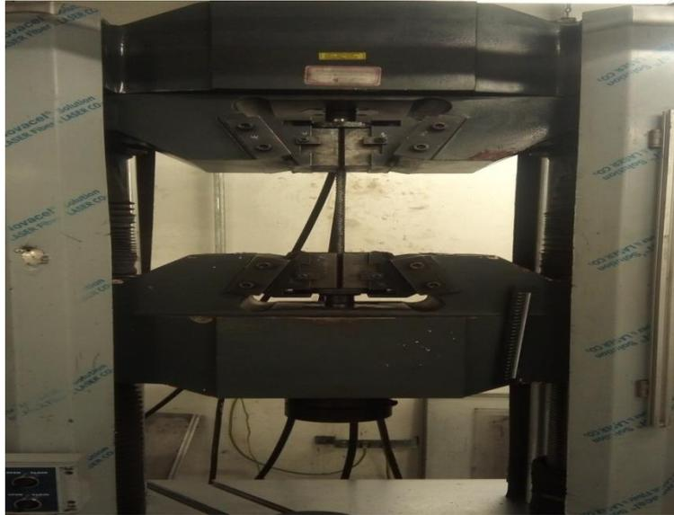
Figure III-15 : La machine de traction pour le fil à machine D>12 mm
