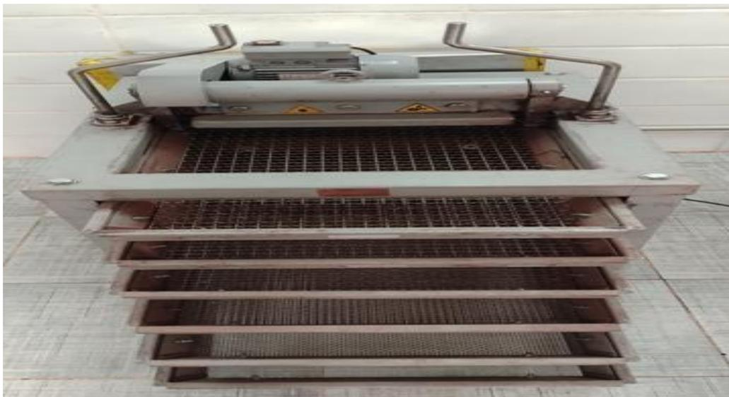
**Figure III-4** . Tamisage automatique vibrant.
