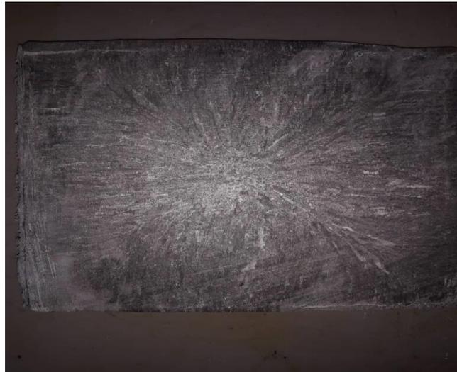
**Figure III-11.** Photo de la macrostructure de la billette après le bain d'acide.
