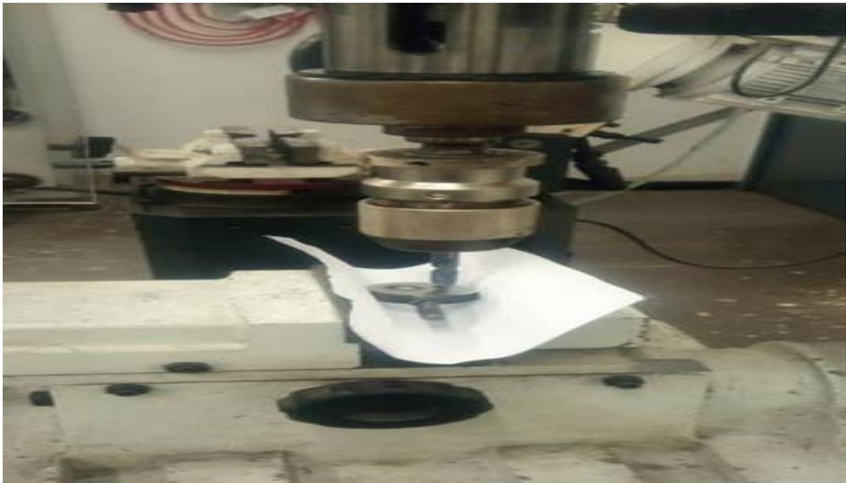
**Figure III-12:**Perçage de l'échantillon.
