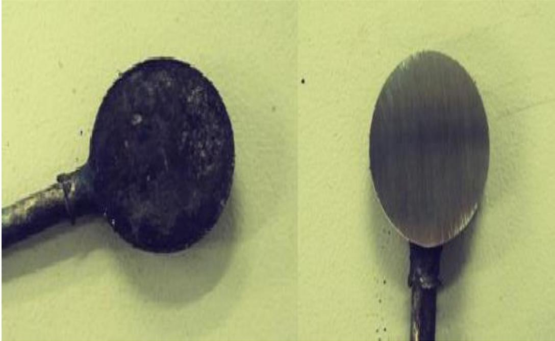
**Figure III-8:** La forme d'échantillon **a)** avant le polissage et **b)** après le polissage.
