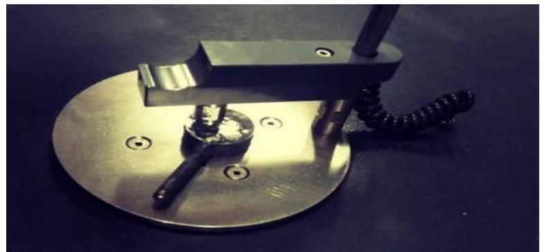
Figure III-10.a) Spectromètre d'émission optique, b) placement d'échantillon dans le spectromètre.
