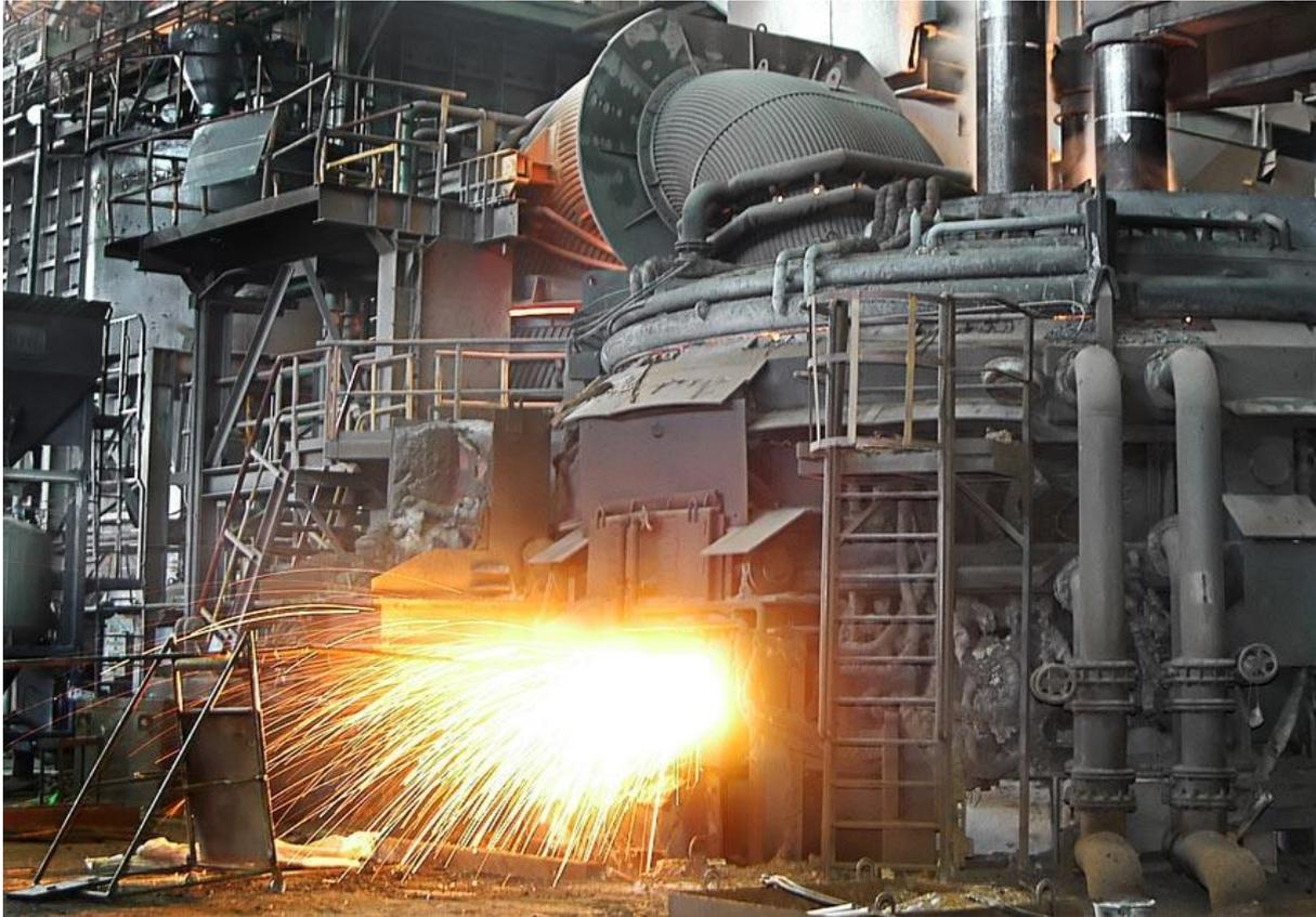
**Figure II-7 :** Four à arc électrique (EAF) [3].
