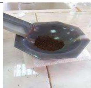
**Creuset en porcelaine** : est un pot en matériau réfractaire utilisé pour la calcination, elle est capable de résister mécaniquement à des températures élevés sans contaminer la poudre.
