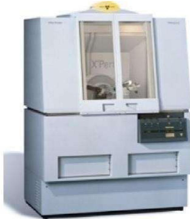
**Figure II.2:** Diffractomètre XPERT-PRO utilisé pour l'enregistrement des diffractogrammes [2].
