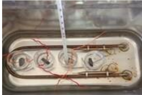
Figure II.3 : Dispositif expérimental utilisé lors des mesures gravimétriques.
