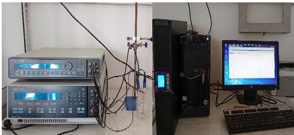
Figure II.4: Dispositif expérimental utilisé lors des mesures électrochimiques.
