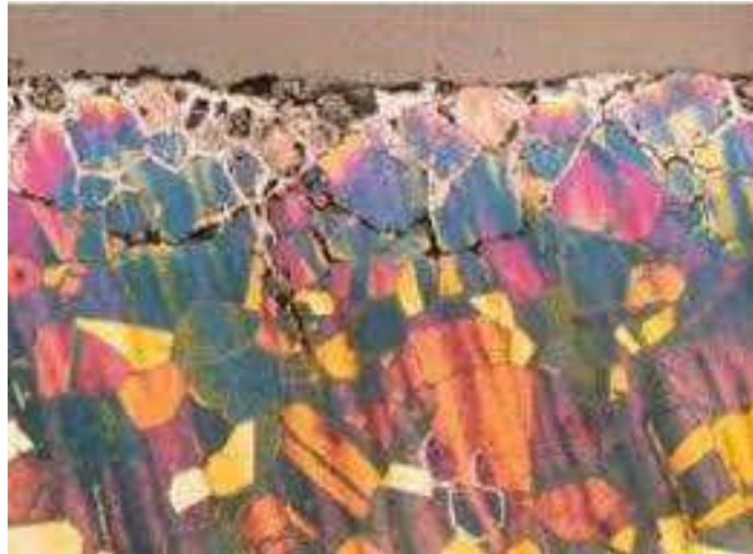
Figure (I ,2) : Corrosion inter granulaire [5]
