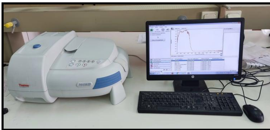
Figure III.7. Dispositif expérimental pour les mesures du gap optique.
