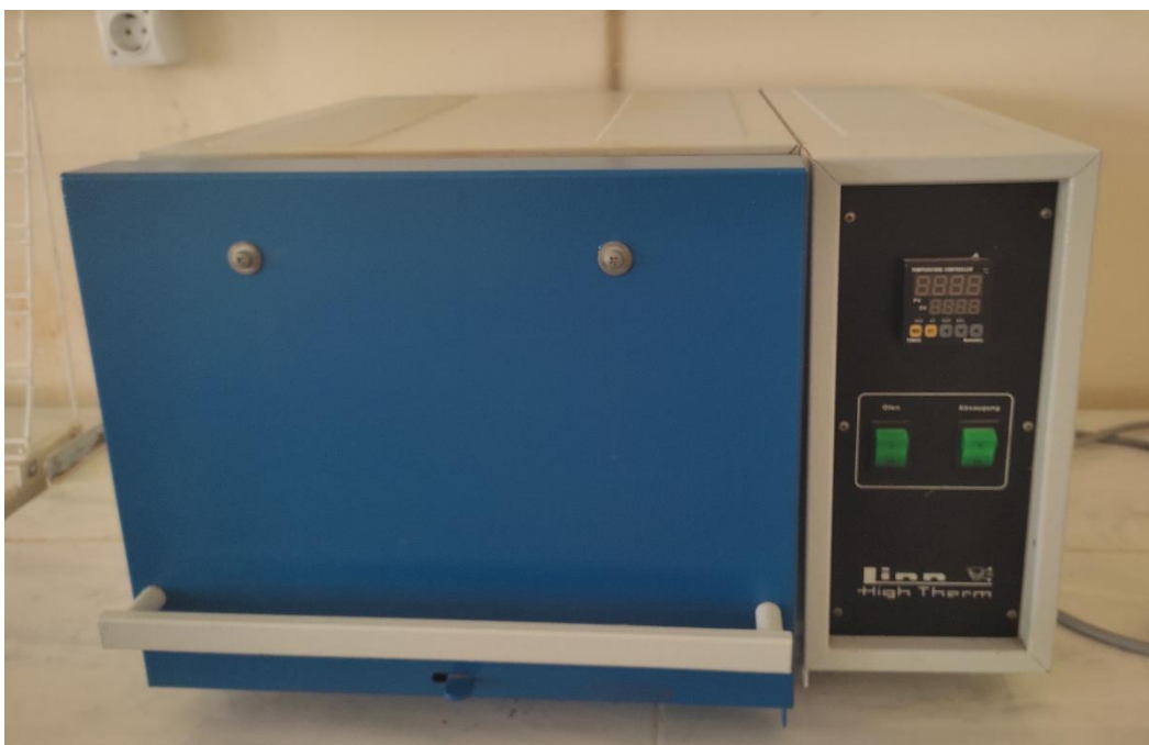
Figure II.1 : four à moufle sous air LINN HIGH THERM GMBH WERK II "MUFELOFEN LM 213.07 mit Regler G 400"
