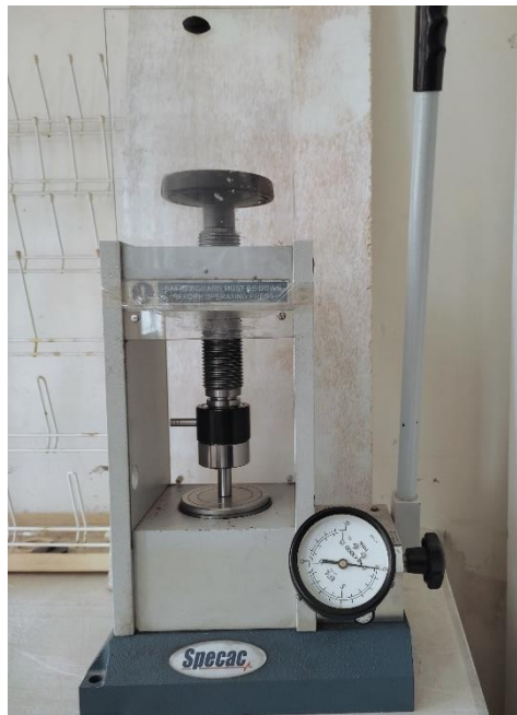
Figure I.5 : Illustration et image de la presse unie axiale à froid utilisée pour le compactage de la poudre.
