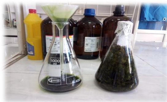
Figure V.2 : La filtration à l'aide du papier filtre
