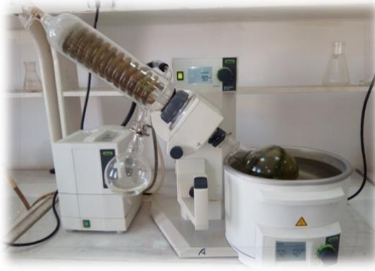
Figure V.3 : Evaporation des trois phases
