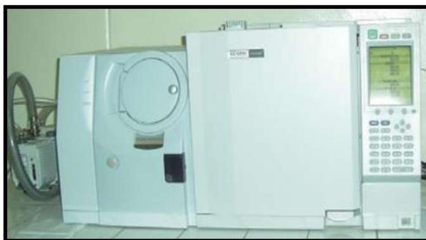
**Figure 47:** Appareil de chromatographie en phase gazeuse couplée à la spectrophotométrie de masse.
