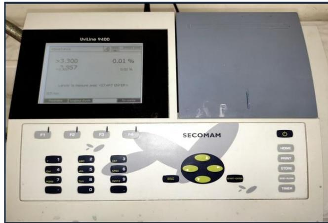
Figure III.8 : Spectrophotomètre UV/VIS utilisé.
