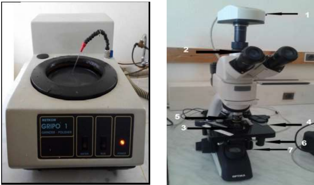
Figure II.4. (a) Machine de polissage mécanique utilisée, (b) Microscopie optique utilisé pour les observations métallographiques (1) Caméra d'acquisition, (2) Oculaires, (3) Table porte échantillon, (4) Echantillon, (5) Objectif, (6) Boutons de déplacement horizontal, (7) Bouton de montrée verticale rapide.
