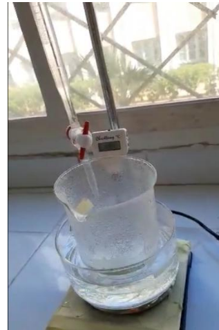
2 Le mélange et chauffage à 80°C
