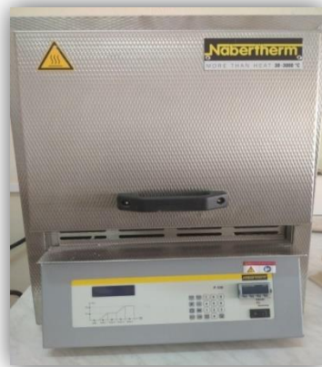
Figure II-10: Four de type « Nabertherm» utilisé dans les frittages des échantillons.
