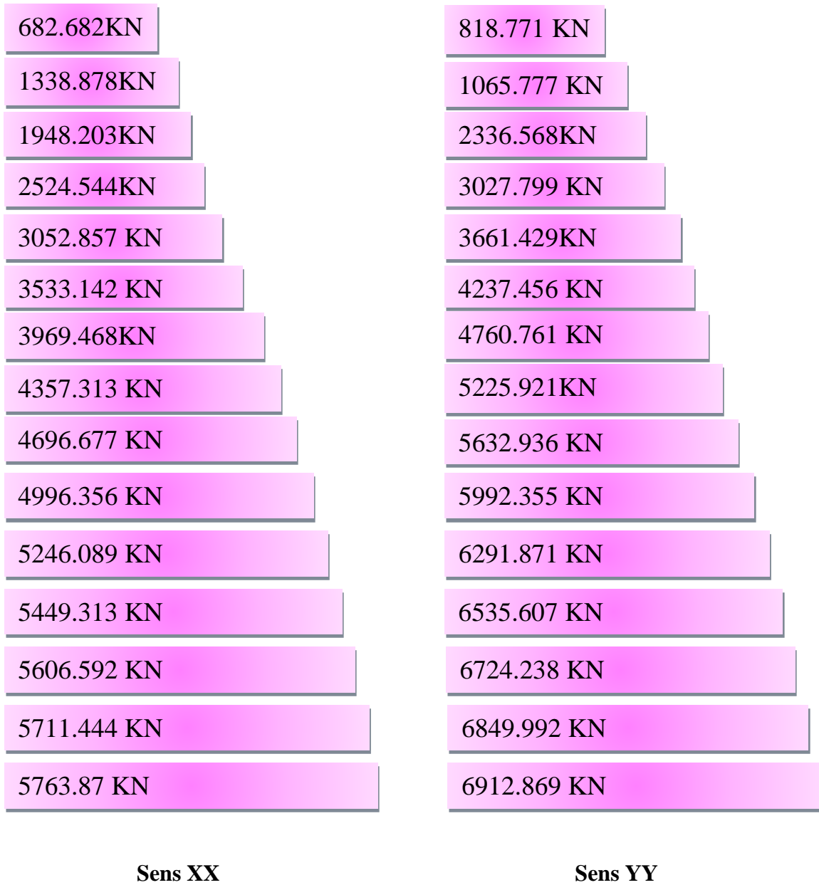
Figure.IV.11 : Distribution de l'effort tranchant selon la hauteur.
