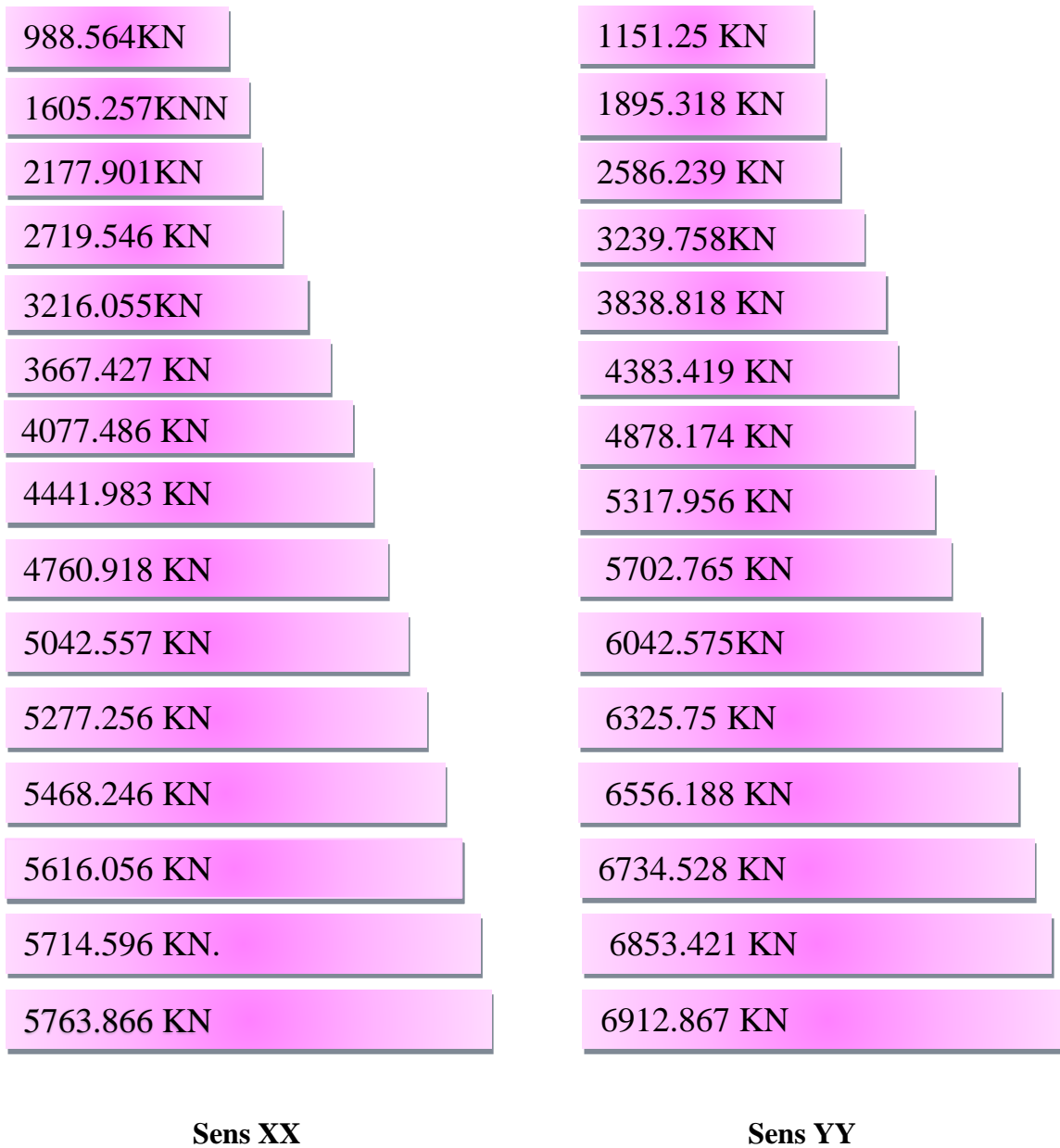
Figure.IV.9 : Distribution de l'effort tranchant selon la hauteur.
