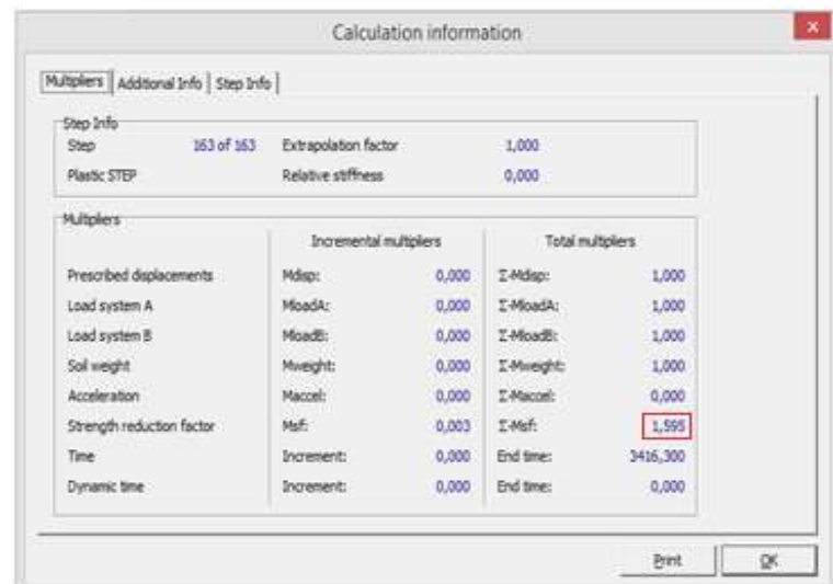
Figure V.14 : coefficient de sécurité ( F_s = 1,595 )
