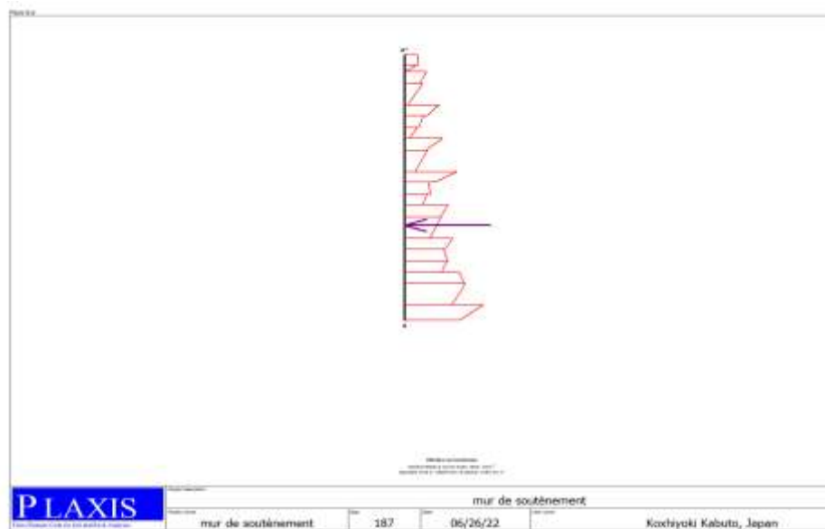
Figure V.7 : diagramme des contraintes effectives horizontales ( \sigma'_{(h)max} = -66,07 \text{ KN/m}^2 )
