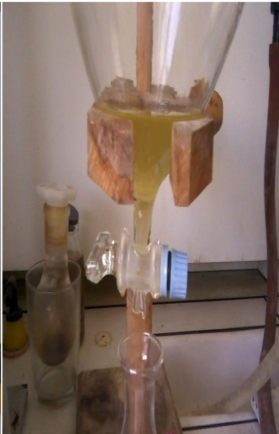
Figure 40 : Décantation du biodiesel
