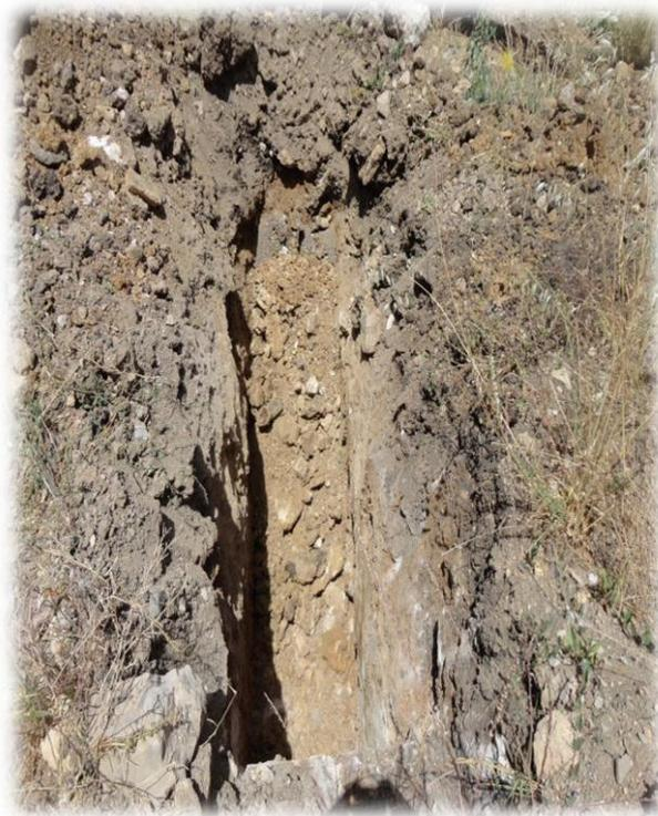
Puits 5 PK 14+025.42 (*limon argileux. Surmonté par une décharge.*) . [11]
