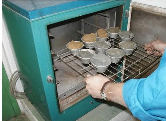
**Figure VII.01:** Essai teneur en eau. [12]
