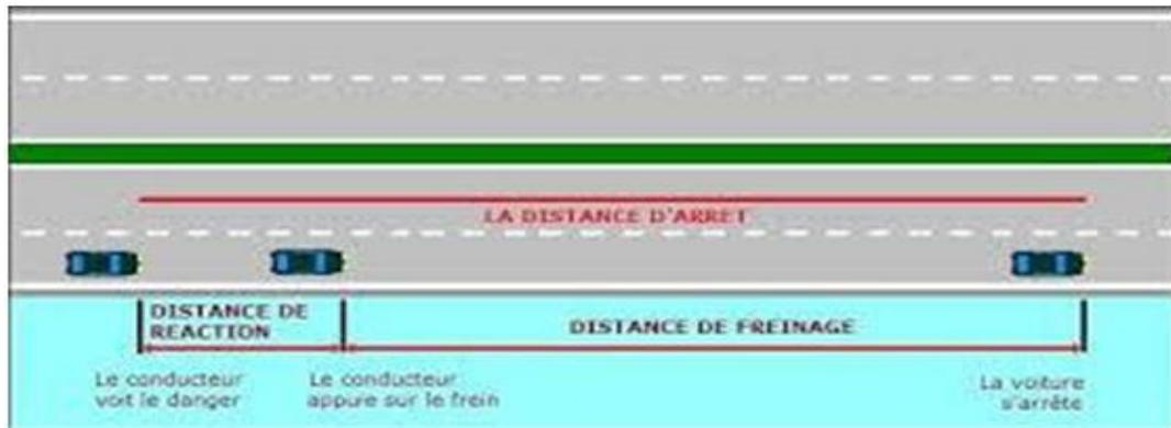
Figure II.07 : distance d'arrêt
