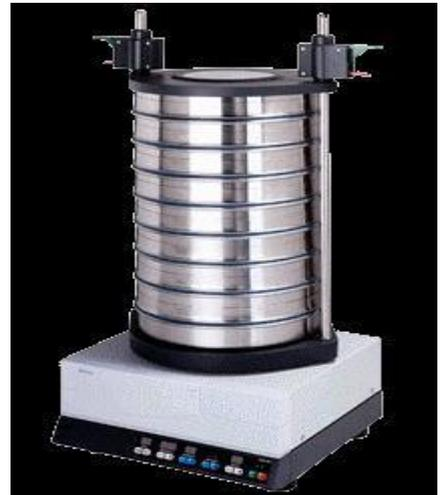
Appareil pour essai granulométrie
