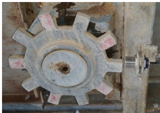
Figure 1.26. Capteur de proximité face à l'engrenage tournant
