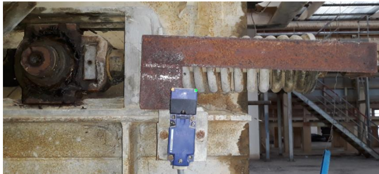
Figure 1.27. Capteur de proximité détectant un convoyeur coincé
