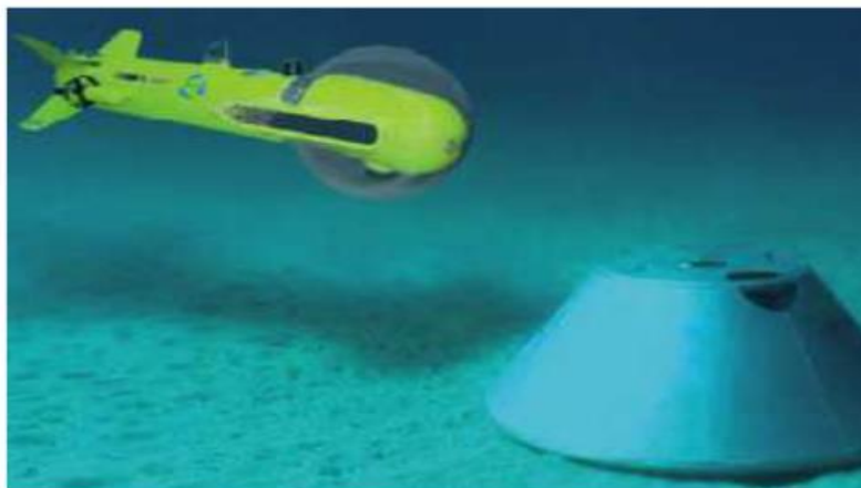
Figure I.5:Le K-Ster (France) à l'approche d'une mine de fond
