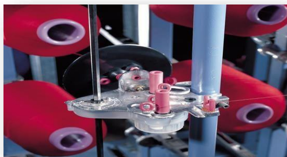
Figure 06 : Dispositif de tension de fil sur cantre d'ourdissoir [3]
