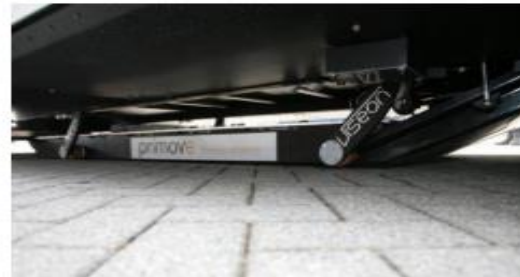
Fig.I.24 Secondaire du système Primove développé par Bombardier, (a) secondaire pendant le déplacement, (b) secondaire abaissé lors de la recharge [4]
