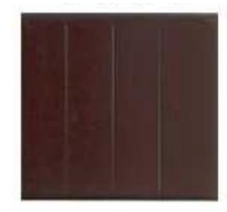
Figure I.7 : Cellule au Silicium amorphe
