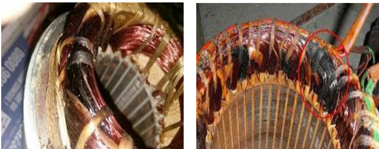
Figure I.11. Exemple de dégâts provoqués par les défauts de courts-circuits statoriques
