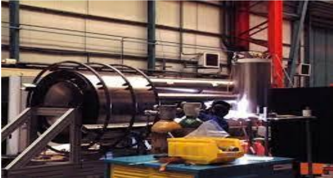
Figure II.3 : Bobine supraconductrice pour stockage d'énergie.
