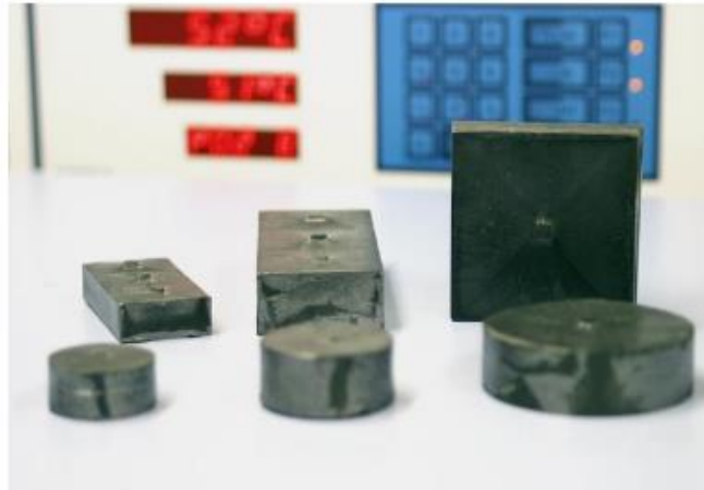
Figure I.11 : Exemple de matériaux supraconducteurs massifs de composition YBCO commercialisés par l'entreprise EVICO [10].
