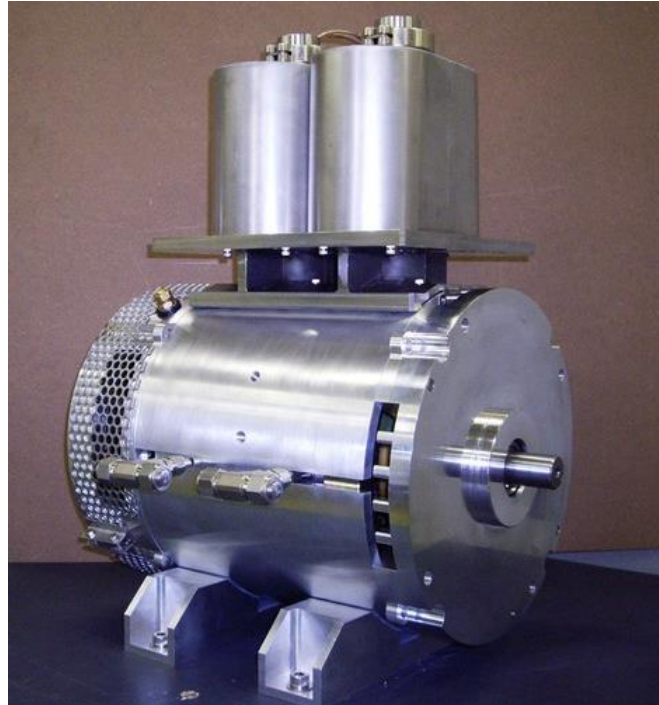
Figure II.4 : Moteur supraconducteur fabriqué par Sumitomo
