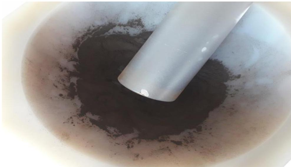
**Figure II.7:** Broyage de la poudre obtenue par la méthode sol gel.
