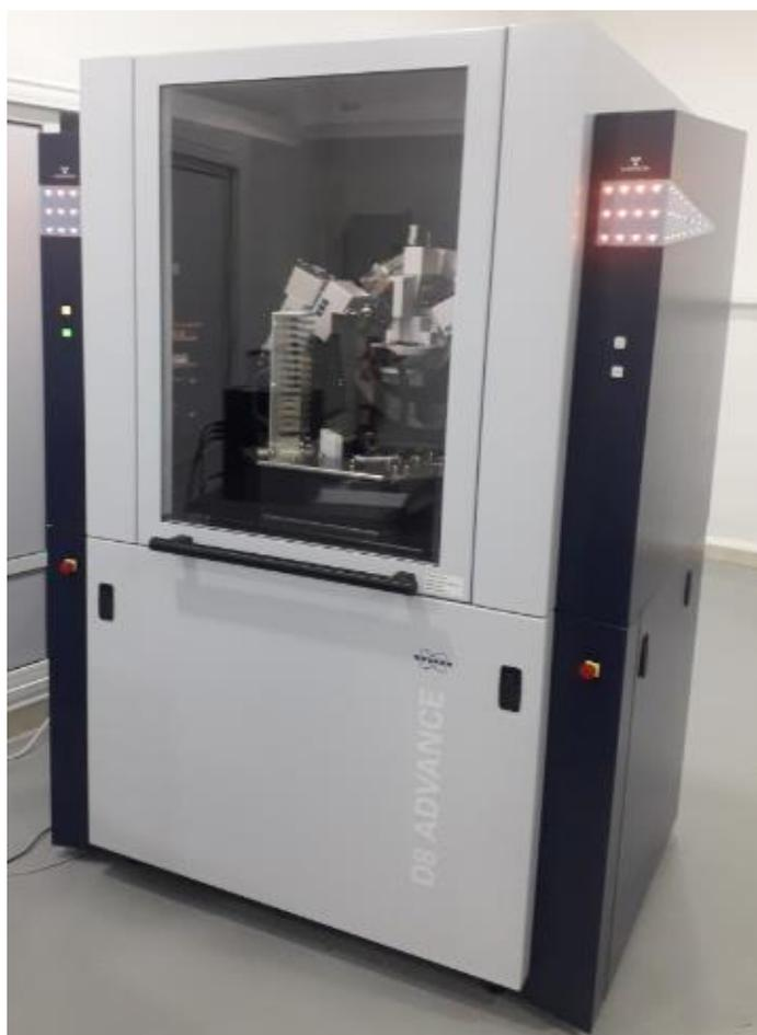
**Figure II.15:** Photographie d'un diffractomètre des rayons X, marque BRUKER D8, ENP de Constantine.
