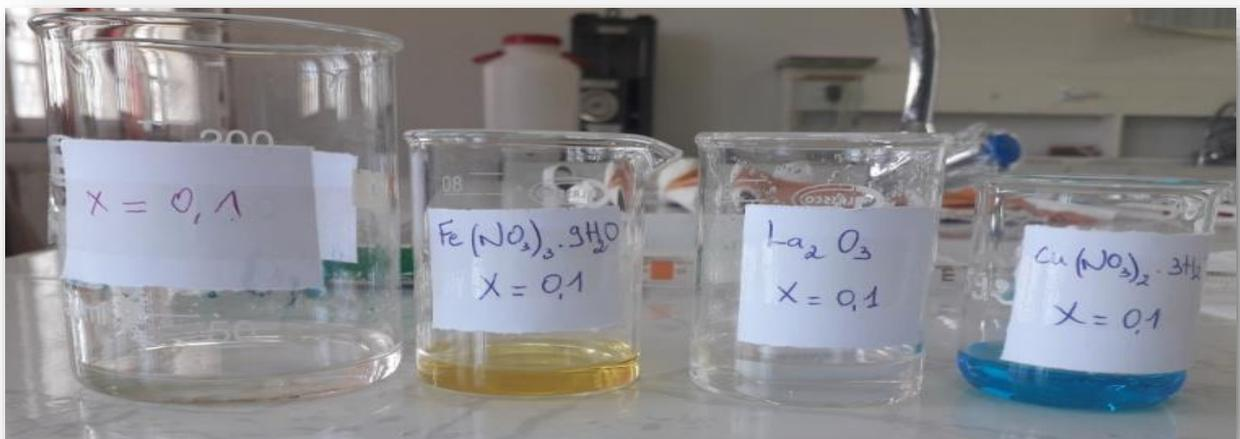
**Figure II.4:** Dissolution des précurseurs utilisés dans la synthèse des deux séries LCF et LCN.
