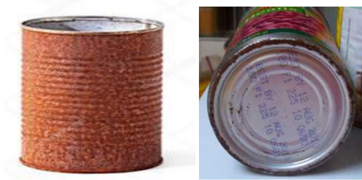
Figure II.12: Corrosion externe de la boîte de conserve (Himeur et Serhane, 2019).
