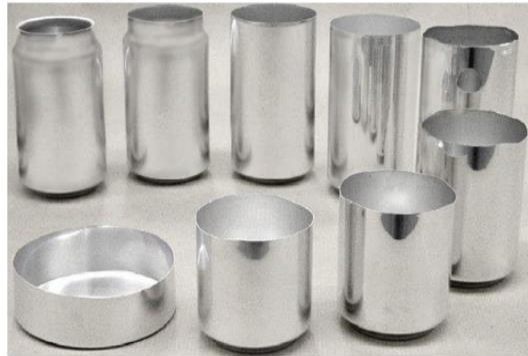
Figure I.4 : Etapes de fabrication de la canette en aluminium (Sail, 2018).
