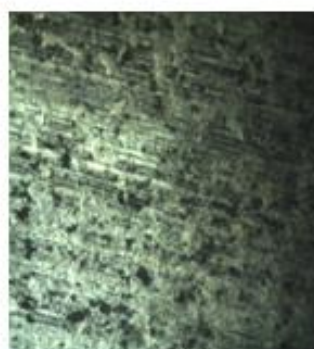
Figure V.18: Micrographies traduisant l'effet protecteur de l'inhibiteur sur le comportement à la corrosion du fer blanc ESB dans la saumure simulée.
