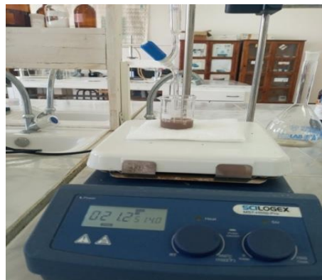
Figure IV.7: Dispositif utilisé pour le dosage des chlorures.
