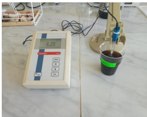
Figure IV. 6: Mesure du pH à l'aide d'un pH mètre.
