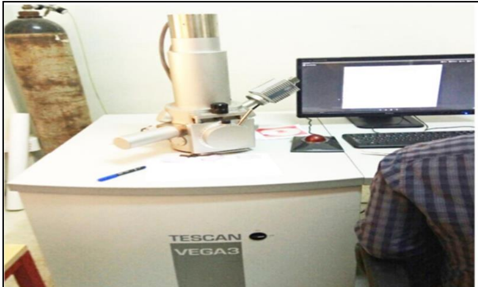
الشكل (6.II): صورة للمجهر الالكتروني الماسح (MEB) [46]
