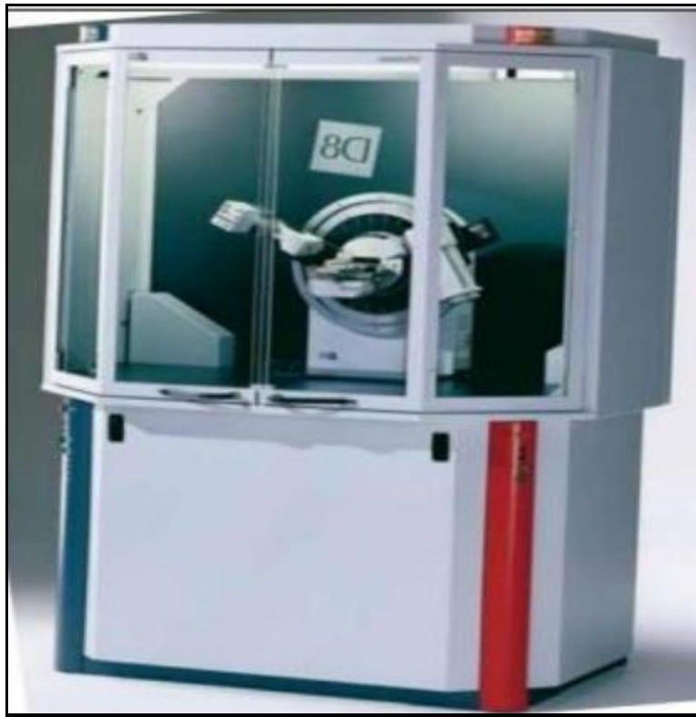
الشكل (3.11): صورة لجهاز انعراج الاشعاعات السينية [39]
