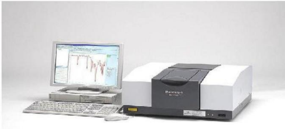
الشكل (14.11): صورة لجهاز مطيافية الأشعة تحت الحمراء [53]
