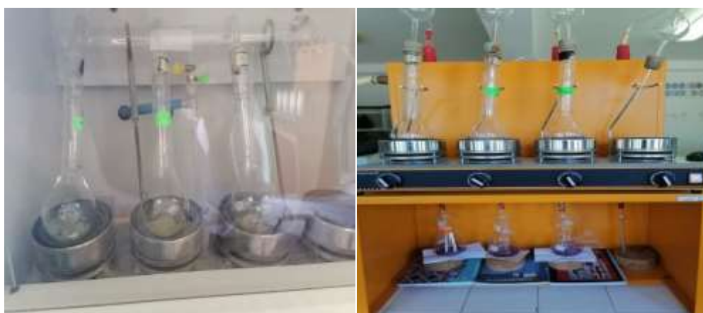
Figure09 : Dispositif de Kjeldahl (dispositif de minéralisation, dispositif de distillation)
