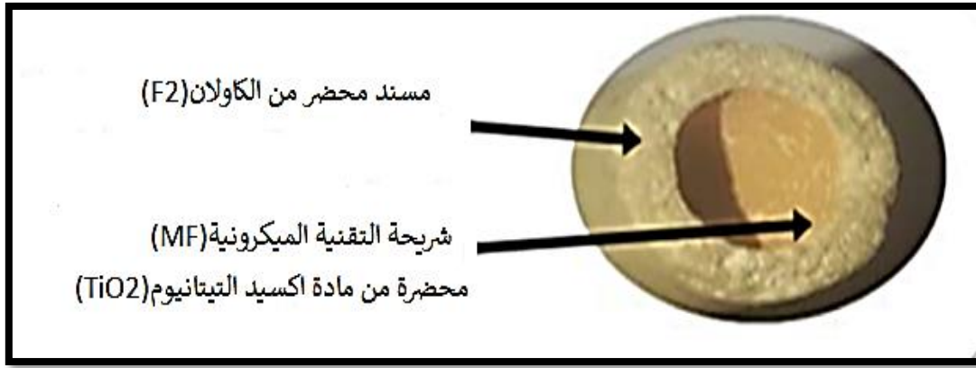
الشكل (13.III): الشريحة بالتقنية الميكرونية الموضوعة على مسند.
