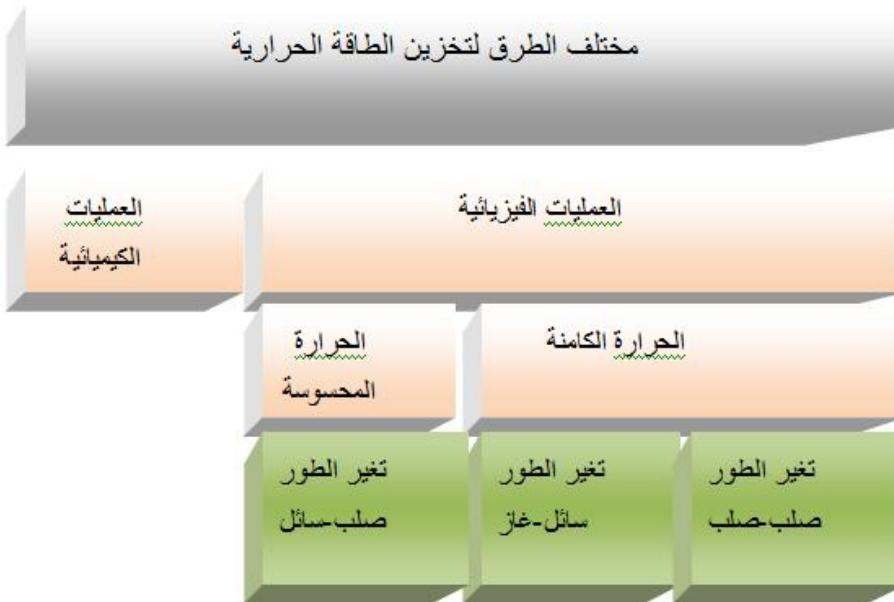
الشكل 1-5 : مختلف الطرق الممكنة لتخزين الطاقة الحرارية [5].
