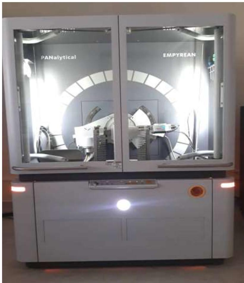
**Figure II.9.** Diffracto mètre de rayon X.
