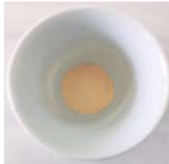
Figure II.8. 5%  $\text{Fe}_3\text{O}_4/\text{CeO}_2$  préparé
