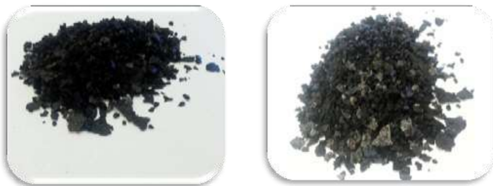
Figure III.13 : Précipité de FeS (débris de corrosion) récupéré de la solution d'amine au niveau des filtres
