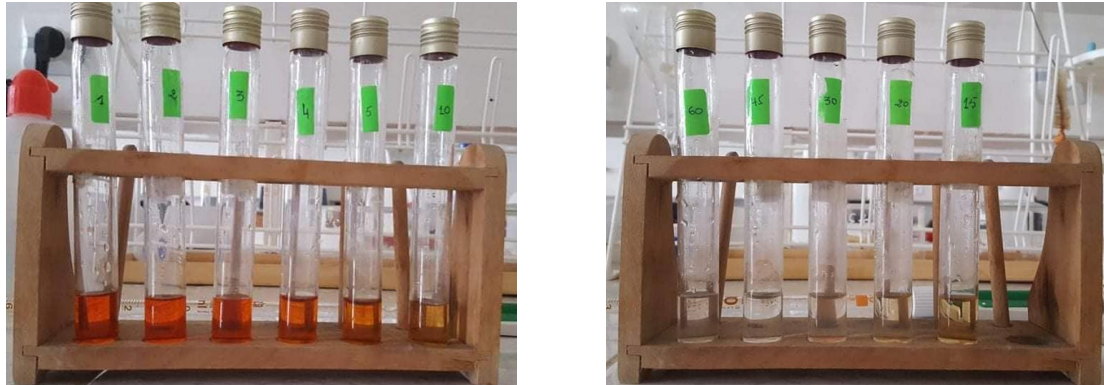
Figure II.12 : Formation du complexe pour le dosage du fer
