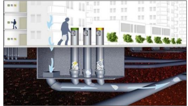
Figure II-17 : Aspiration des déchets par succion
