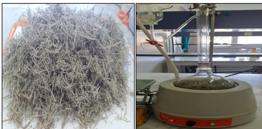
Figure 14. Extraction des huiles essentielles d' Artémisia herba alba par hydrodistillation (Appareil de type Clevenger)
