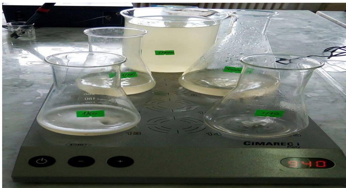
Figure 08 : Les échantillons avec les différentes dilutions placés sur agitateur multiposte
