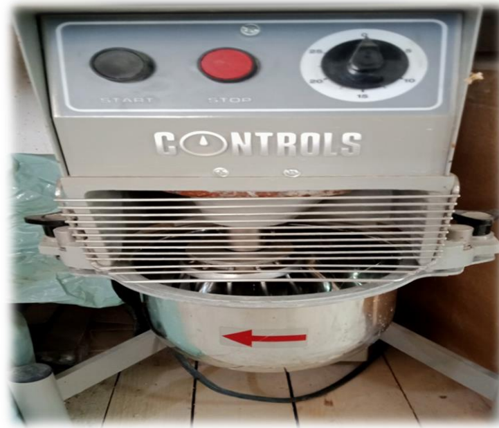
Fig. IV.4. Malaxeur à mortiers utilisé pour la fabrication des éprouvettes
