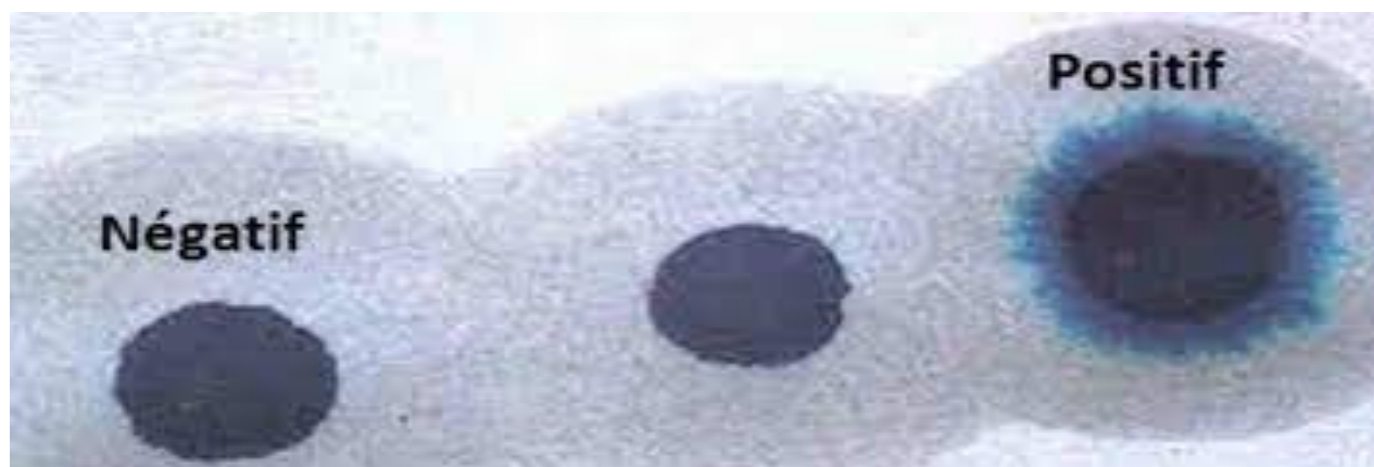
FigIII.15. Explication de l'essai au bleu de méthylène
