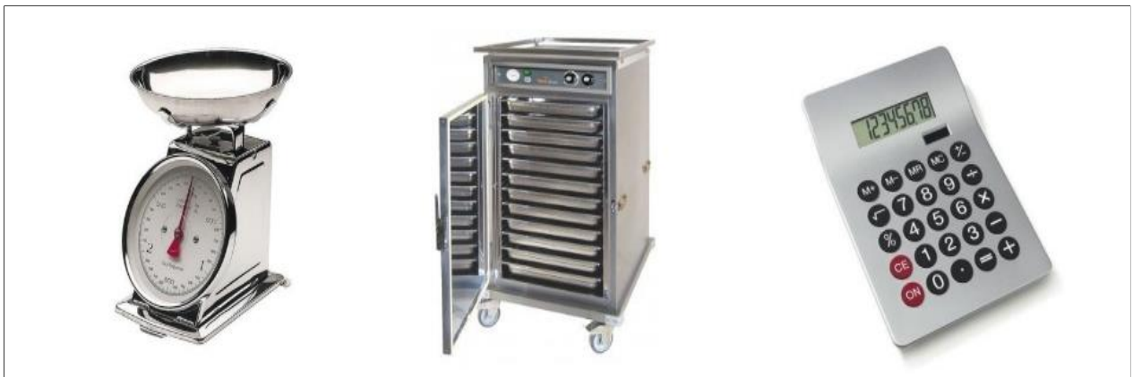
Fig.III.2. Matériel nécessaire pour l'essai de la teneur en eau.
