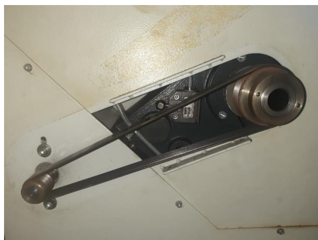
Figure II. 4: Réducteur poulies/ courroie plate pour le mandrin.
