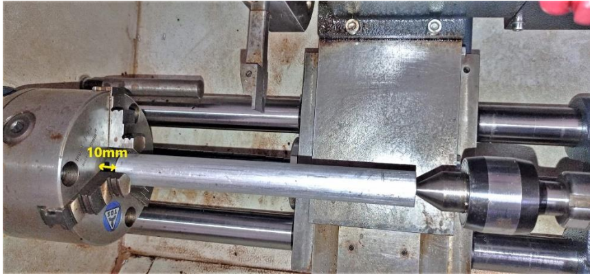
Figure V. 13 : Emplacement de la pièce brute.
